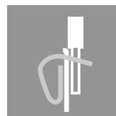
柔軟な配線作業に対応し、高い耐振動性を備えた Klippon Connect テンションクランプ式 Z シリーズ端子台はコンパクトで実用性に優れた盤設計に貢献します。ドライバを差し込みながら接続します。
