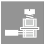
信頼性の高い接続が可能な Klippon Connect スクリュークランプ式 W シリーズ端子台は安全性の高い接続を保障します。ねじ式端子台は安定性や機能性に優れ、今もなお端子台のスタンダードとして使用されています。
