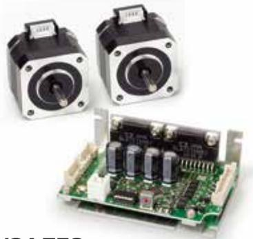
**POINT 1 ドライバ1台でモータ2台を同時駆動**
