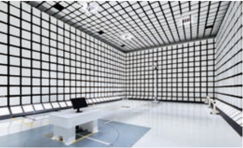
10m法電波暗室
