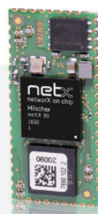
写真: NRP H90-REIF8D8 (SQI FLASH 8MB, SDRAM 8MB搭載)
