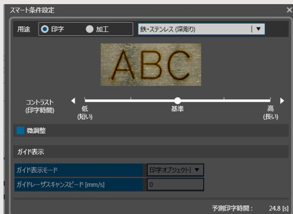
レーザーパワーやスキャンスピード、パルス周波数など印字条件設定のノウハウをワンタッチ機能に集約。14種類に及ぶ材質のイメージから希望の印字状態をワンタッチで実現します。
