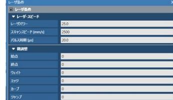
③「テスト印字」でレーザー照射
